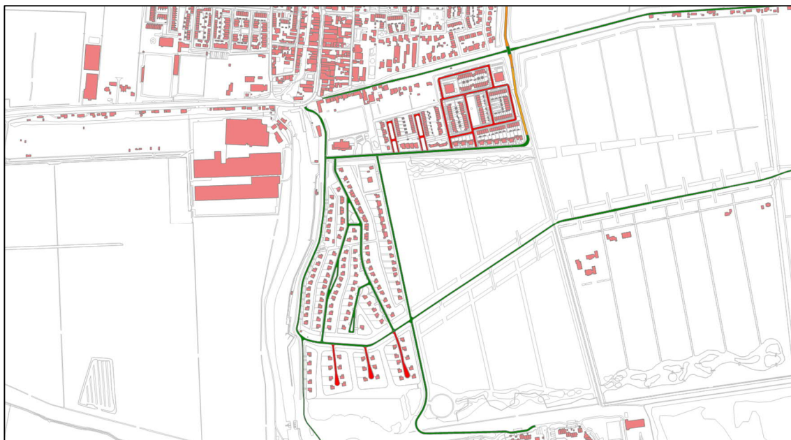
Afbeelding 6 Weergave wegvakken (oranje) met Dubofalt (dunne deklaag type B) op de Torensteelaan en referentiewegdek (groen) en elementenverharding in keperverband (rood)
