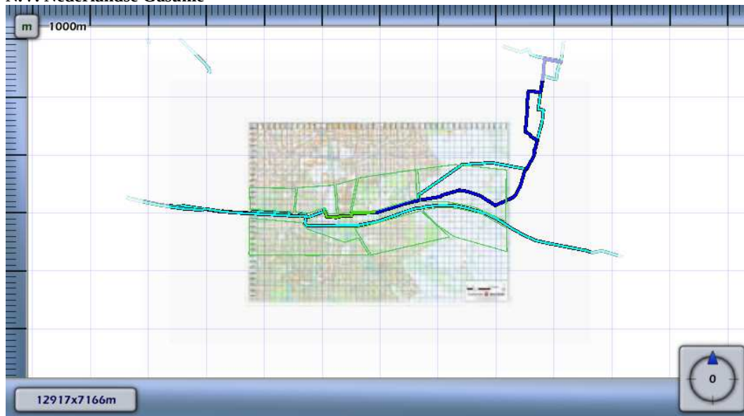
Figuur 4.4 Kilometer leiding behorende bij de maximale overschrijding van de FN-curve voor N-528-50 van N.V. Nederlandse Gasunie
