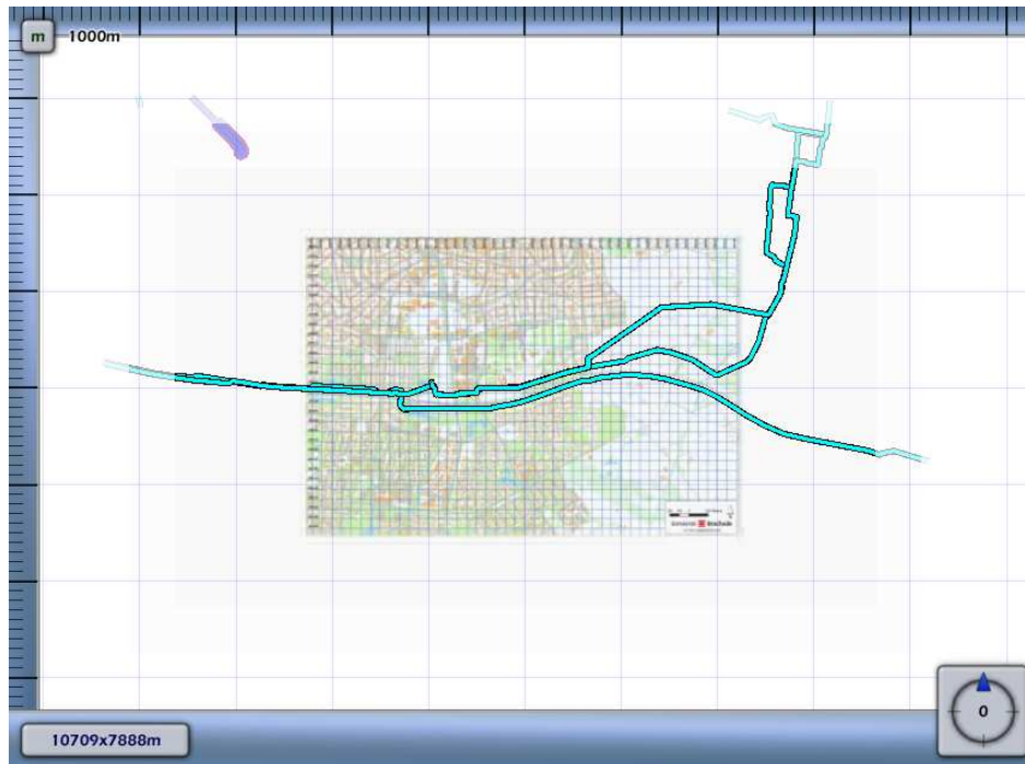
Figuur 3.7 Plaatsgebonden risico voor N-528-75 van N.V. Nederlandse Gasunie
