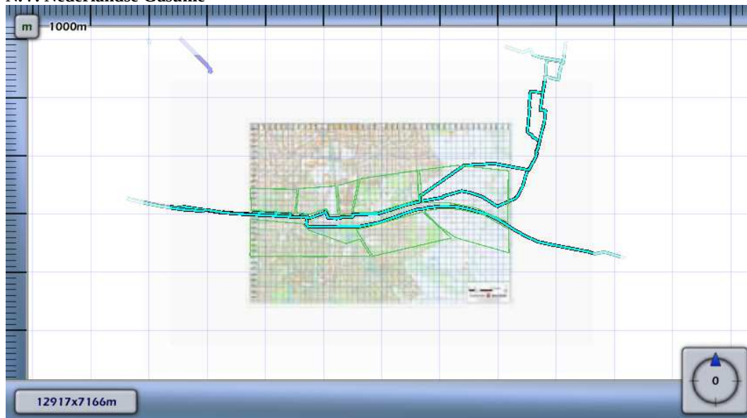
Figuur 4.7 Kilometer leiding behorende bij de maximale overschrijding van de FN-curve voor N-528-75 van N.V. Nederlandse Gasunie
