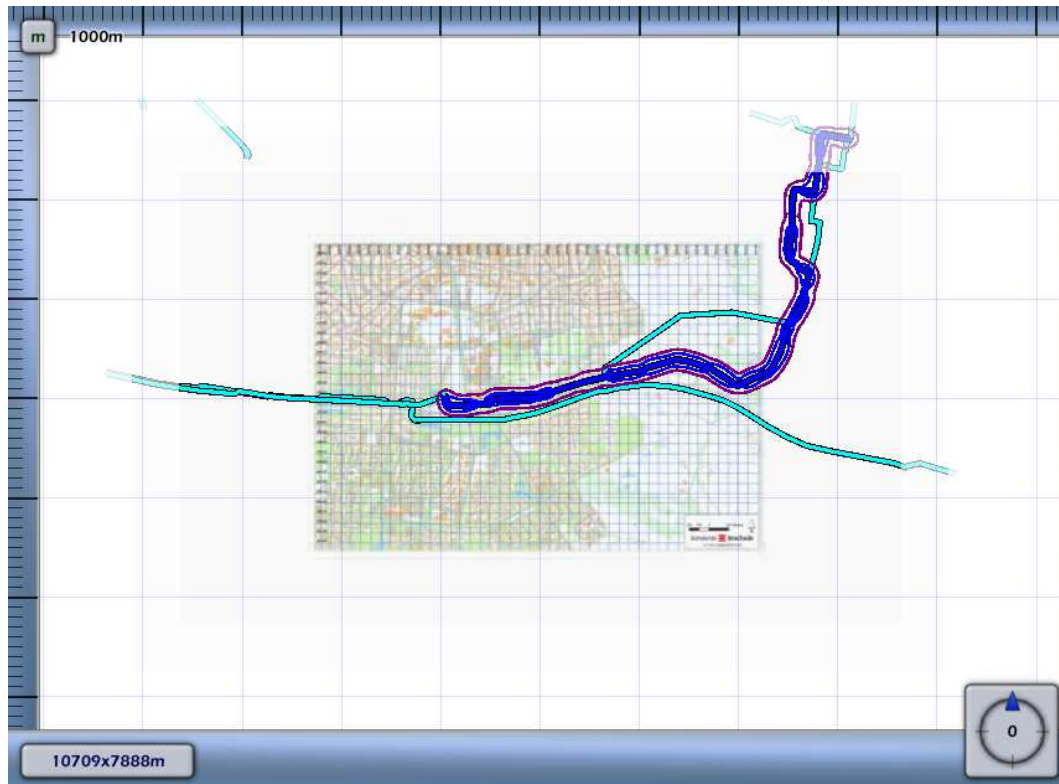
Figuur 3.4 Plaatsgebonden risico voor N-528-50 van N.V. Nederlandse Gasunie
