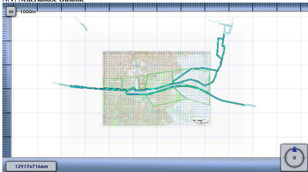
Figuur 4.3 Kilometer leiding behorende bij de maximale overschrijding van de FN-curve voor N-569-69 van N.V. Nederlandse Gasunie
