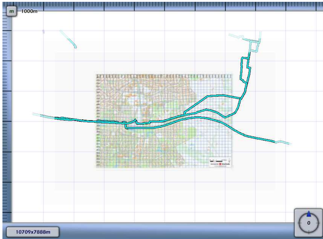
Figuur 3.3 Plaatsgebonden risico voor N-569-69 van N.V. Nederlandse Gasunie
