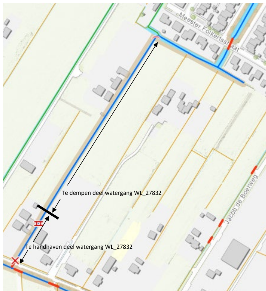
Afbeelding 13 te dempen deel watergang
