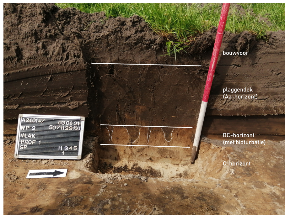
Afb. 3.1 Foto van profiel 201, waarbij de verschillende bodemhorizonten zijn aangegeven.
