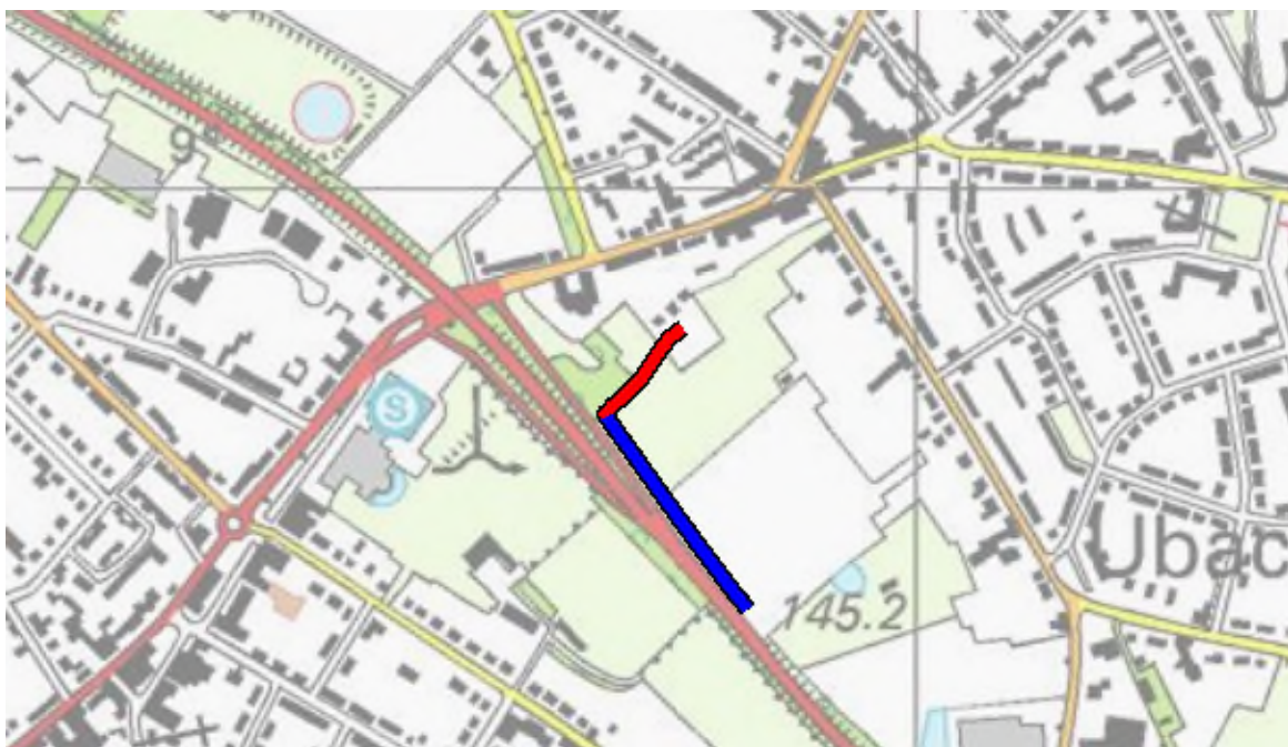
Figuur 2 Ligging van het nieuwe gedeelte van de Z-503-09 (rood), het blauwe gedeelte van de leiding is verwijderd.
