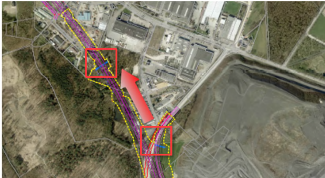
Figuur 3.17. Ligging gewijzigde faunapassage geschikt voor reptielen en amfibieën als gevolg van de verhoogde ligging van het BPL (rechter kader). Middels de aanwezige en te optimaliseren vegetatiestrook (rode pijl) wordt aansluiting gevonden op de linker geprojecteerde faunapassage voor reptielen en amfibieën (linker kader).
