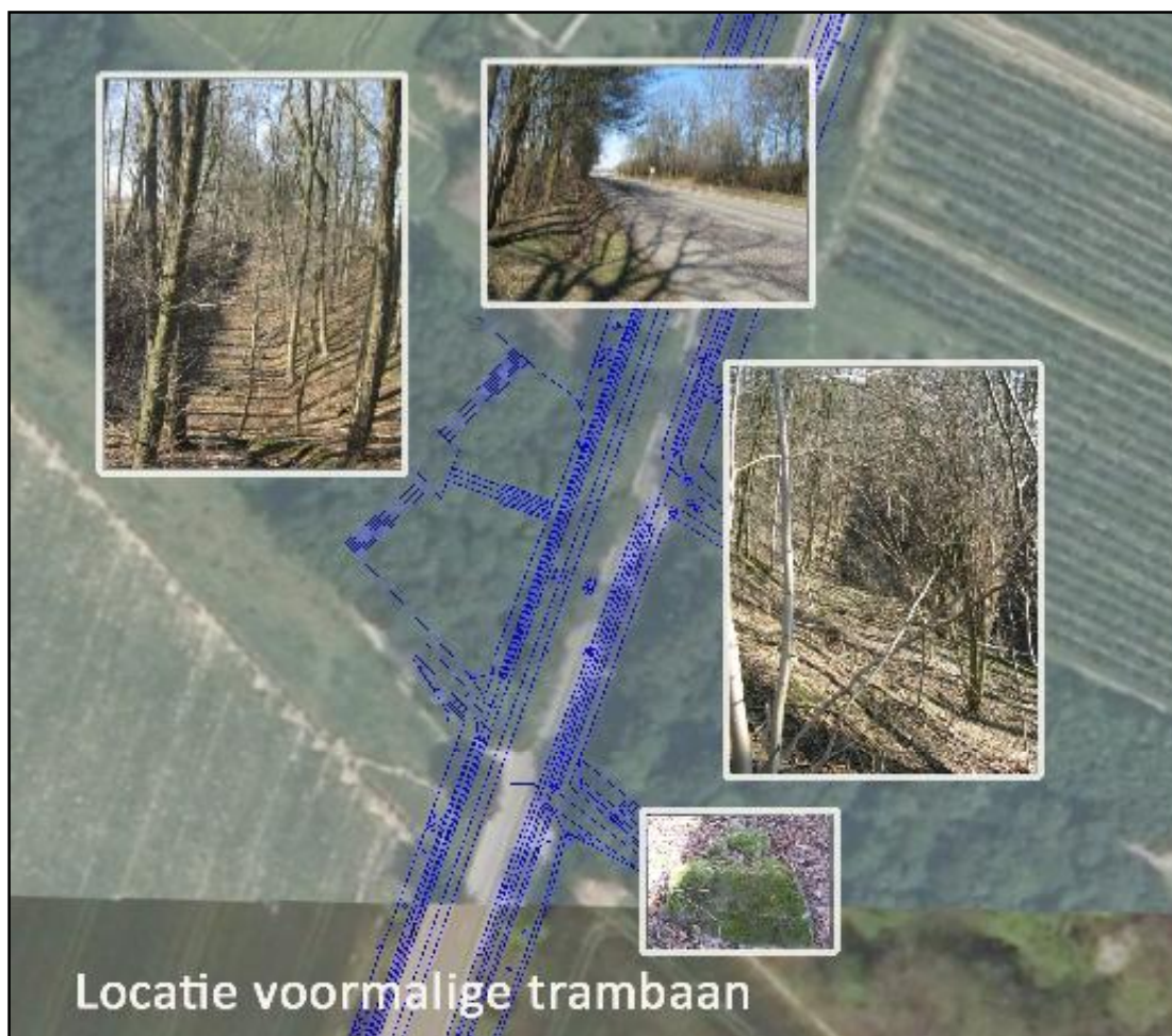
Fig. 34. Locatie N598 ter hoogte van de voormalige trambaan. Het westelijk deel van het verdiepte tramtracé is opgevuld. Her en der liggen brokken puin.
