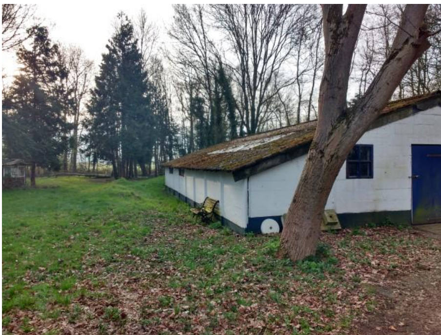
Foto 20: Rijksweg zuid 4 te Kelpen (bebouwing met asbesthoudende golfplaten midden op het perceel)
