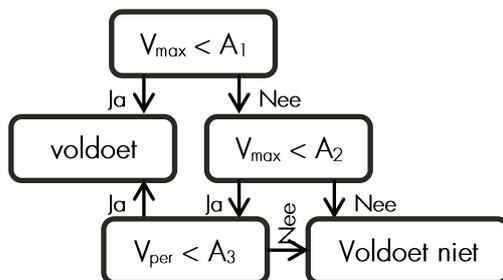
Afbeelding 3 Beoordelingssystematiek  $V_{max}$  en  $V_{per}$
