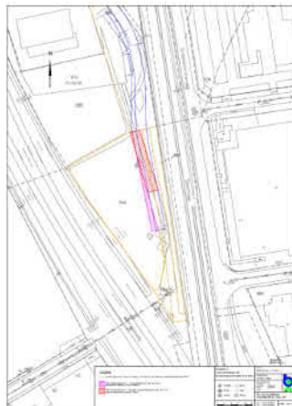
BUS-evaluatie met ligging van de interventiewaardecontour vóór de sanering, Milieutechnisch Adviesbureau Heel BV, 4-10-2011
