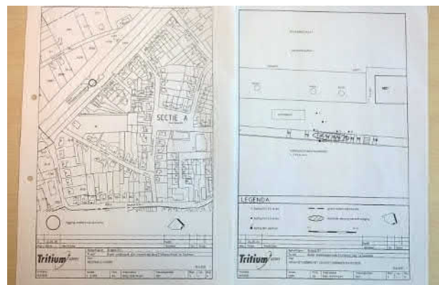
Tekeningen uit het nader bodemonderzoek met ligging grondverontreiniging met olie
