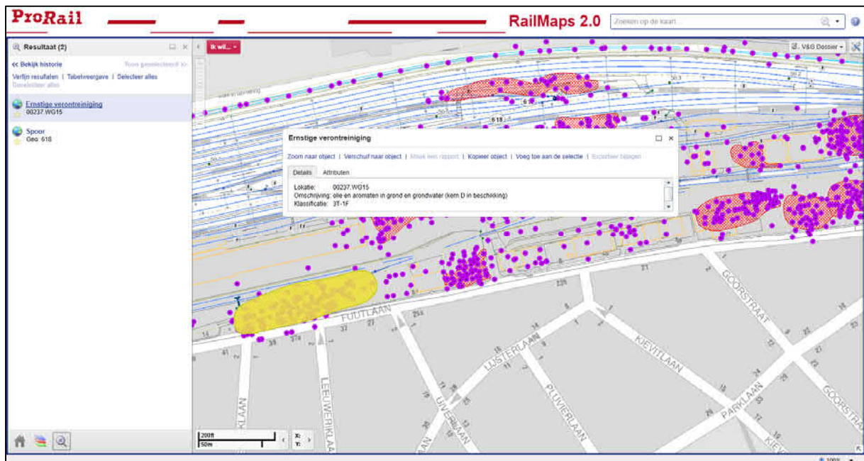
Figuur 2.2 Voorbeeld uit Railmaps: er heeft bodemonderzoek plaatsgevonden (paarse punten), er is sprake van een geval van ernstige bodemverontreiniging (rode arcering aan de oostzijde van het spoor). In 'pop-up' staan nadere gegevens en voorlopige veiligheidsklasse vermeld.
