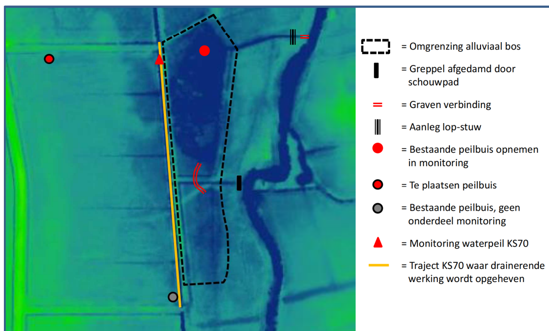
Figuur 1: Kaart uit het monitorings- en inrichtingsplan ( , 2017b), waarop onder andere de te nemen hydrologische maatregelen zijn weergegeven. De afvoersloot plus geplaatste stuw is rechtsboven zichtbaar.
