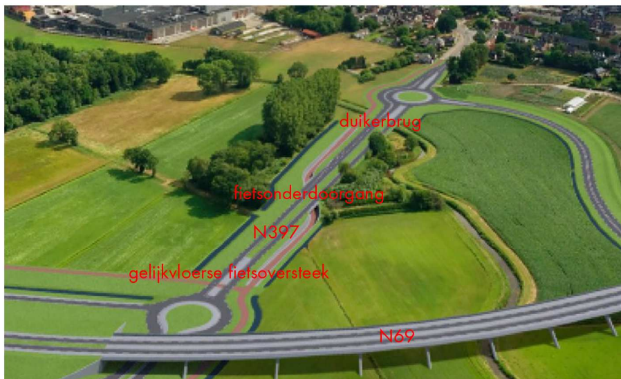
Afbeelding 2. Situatie referentieontwerp met gelijkvloerse fietsoversteek, aparte fietsonderdoorgang en duikerbrug
