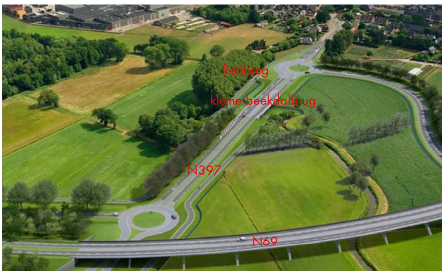
Afbeelding 3. Situatie 'kans' waarbij fietsonderdoorgang is geïntegreerd met onderdoorgang Keersop en gelijkvloerse oversteek is vervallen
