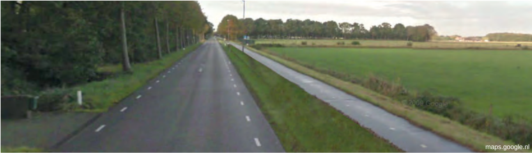
vrijliggend tweerichtingfietspad zonder beplanting in berm
