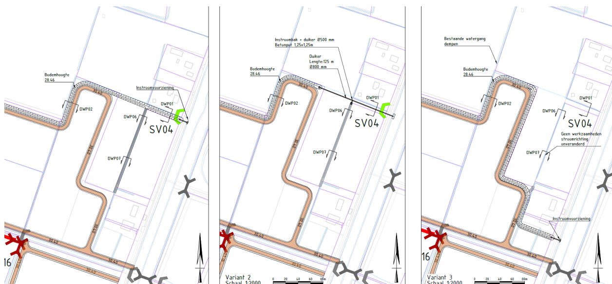
Figuur 4-2: Drie varianten voor de inlaat en tracé noordelijke watergang t.b.v. afwatering Griendtveenseweg
