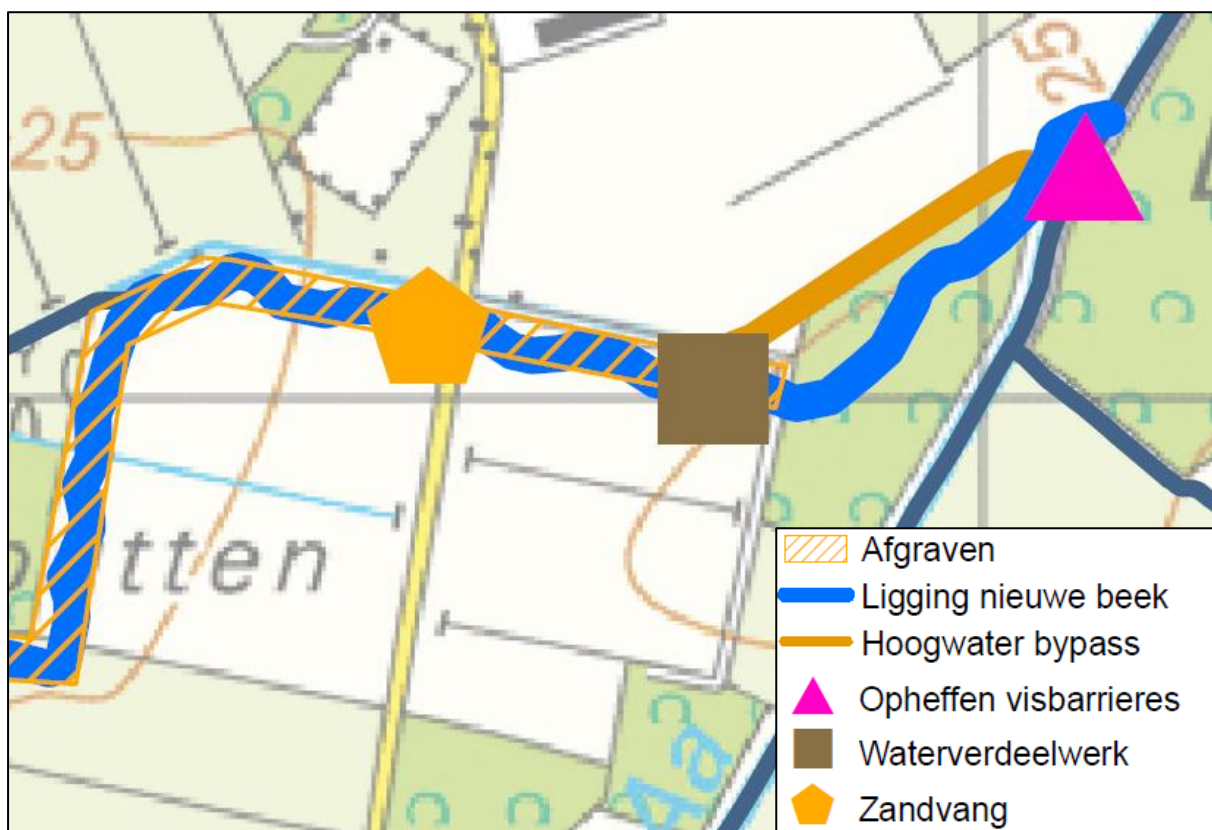
Figuur 3.3: de realisatie van de uitstroomvoorziening van de Oude Strijper Aa in de Strijper Aa.
