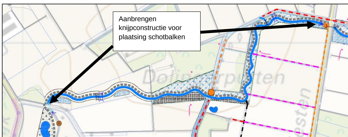
Figuur 3.13: locaties knijpconstructies
