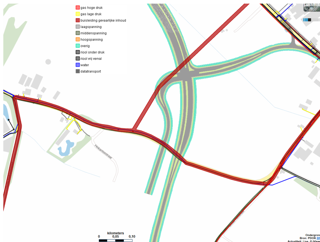
Figuur 3-14: Kabels en leidingen Heikantse straat
