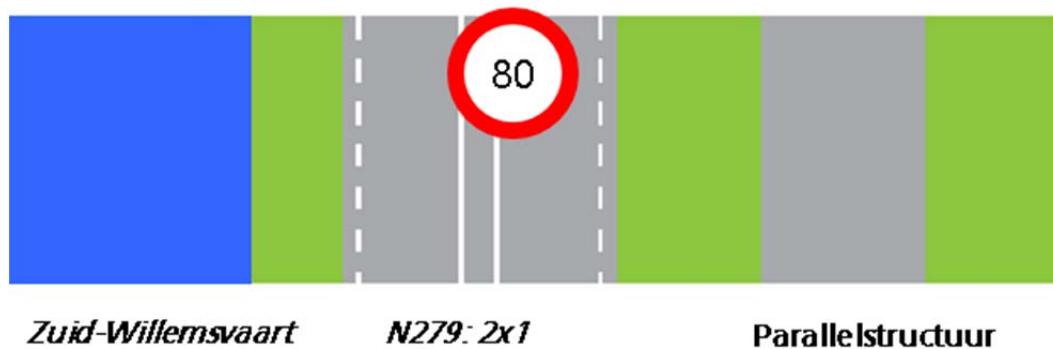
Figuur 3.6: Globaal dwarsprofiel huidige N279, tevens referentiesituatie
