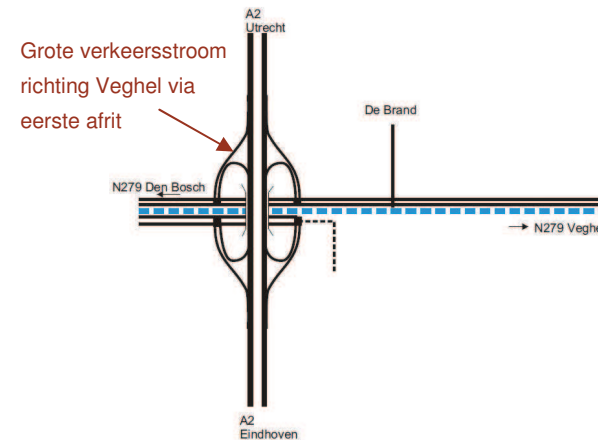
Figuur 2.6: Optie 3: Variant met twee halve klaverbladen op A2
