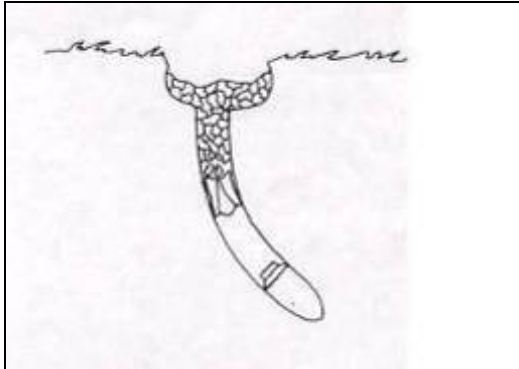
Figuur 4: Doorsnede van een inslagopening van blindganger vliegtuigbom.
