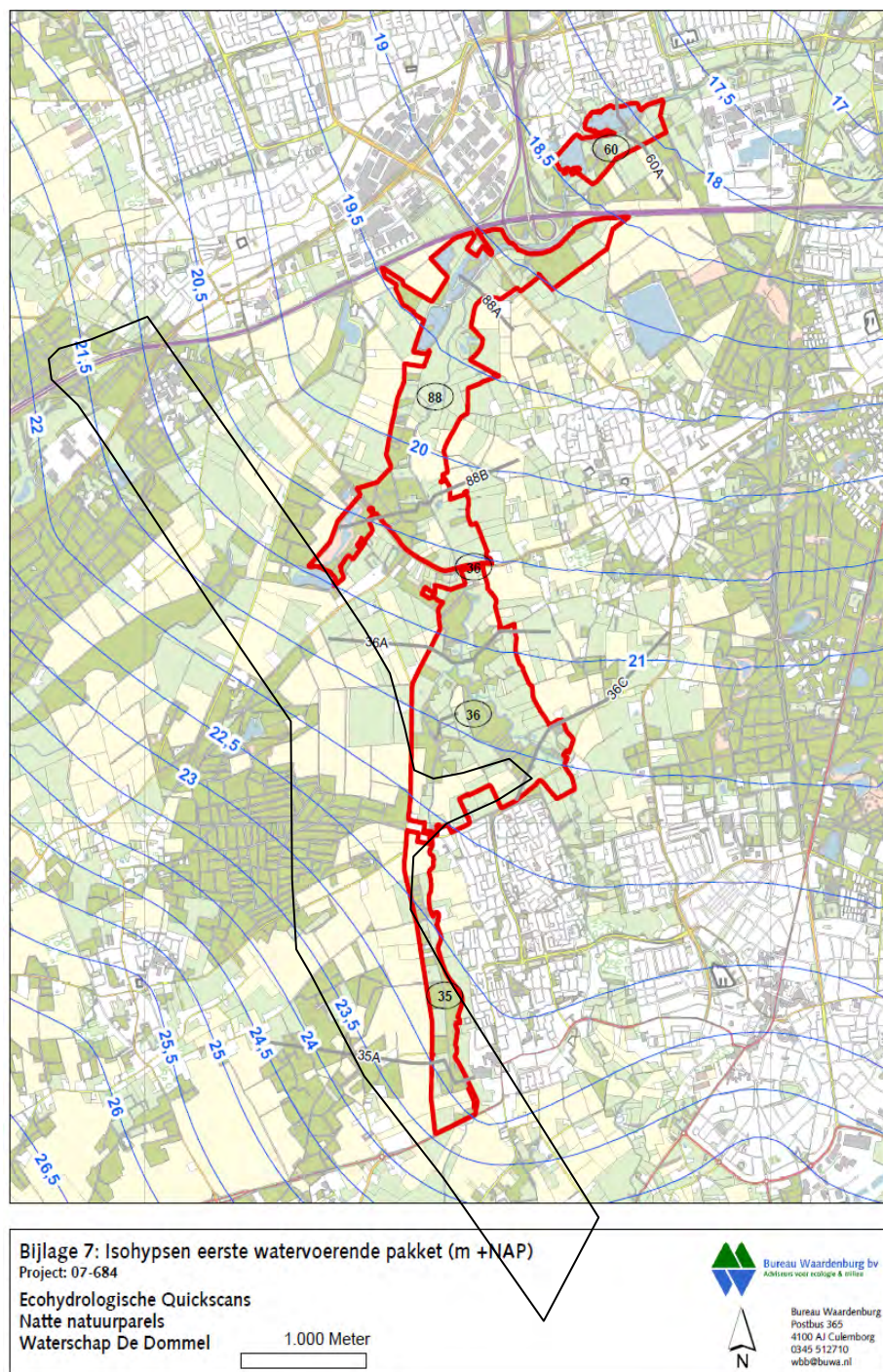
Figuur 4.8 Isohypsens (grondwaterdruk) in het eerste watervoerend pakket
