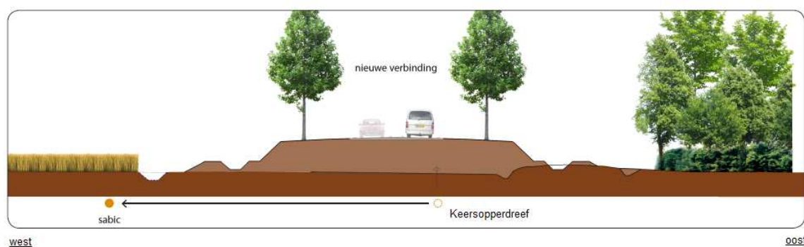
Figuur 9.5: Schematische dwarsdoorsnede van alternatief Co tussen N397 en de weg Keersop
