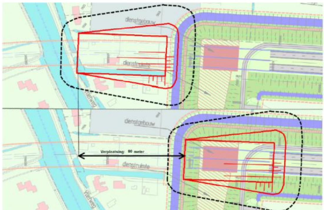
Afbeelding 4 Gewijzigd alignement als gevolg van verplaatsing startschacht (oostzijde)
