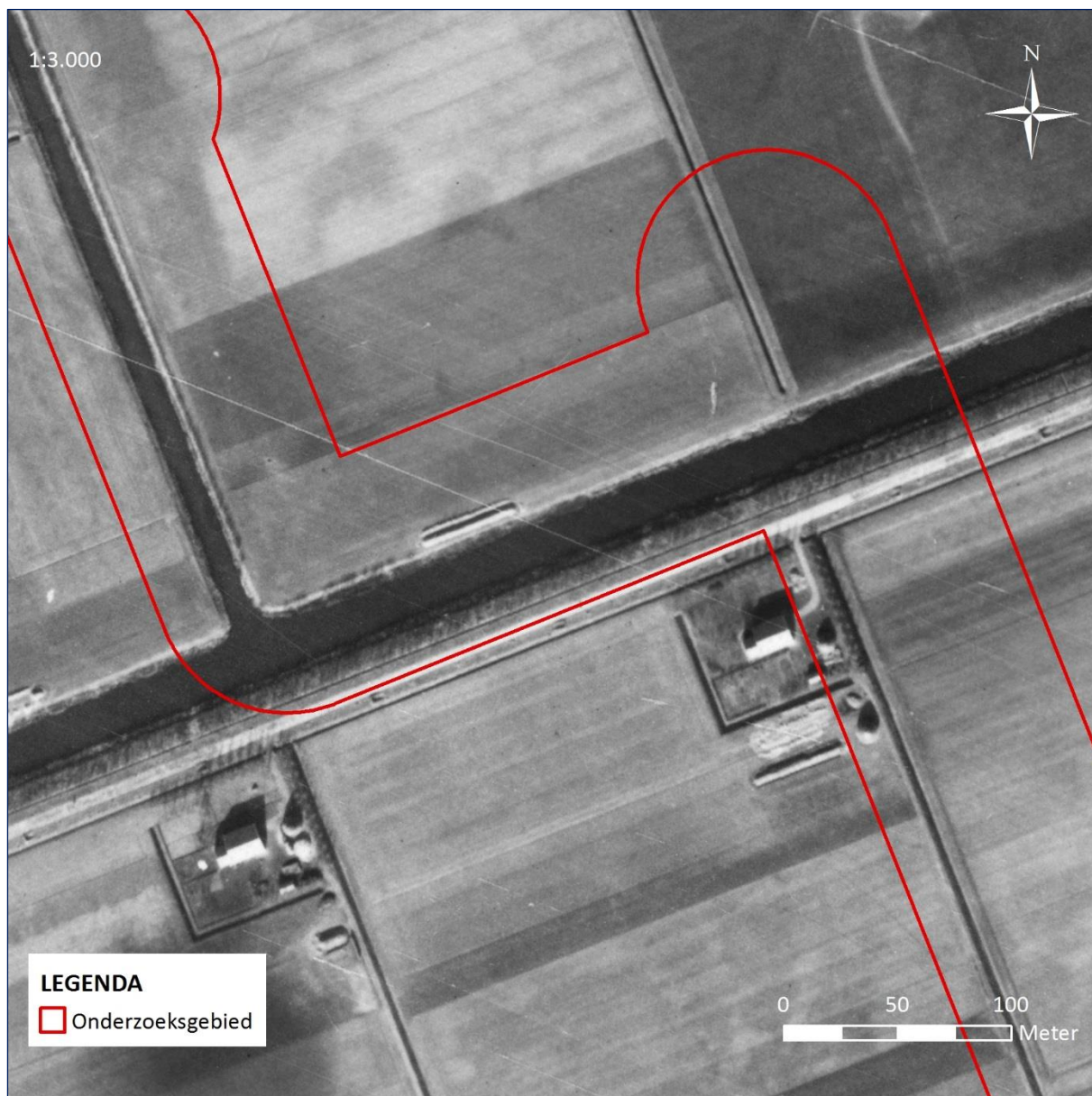
Figuur 23: Detail van een luchtopname van 24 februari 1945 ter hoogte van de Nieuwesluizervaart/ Nieuwesluizerweg ten westen van Slootdorp. De opname toont diverse splitterboxen ofwel vehicle bays , met daartussen schuilmangaten. Deze beschuttingswerken zijn langs meerdere polderwegen langs het onderzoeksgebied waargenomen. De plaatsen konden bij (dreigend) luchtgevaar door (leger)voertuigen en (militaire) personen ter beschutting worden ingenomen.
