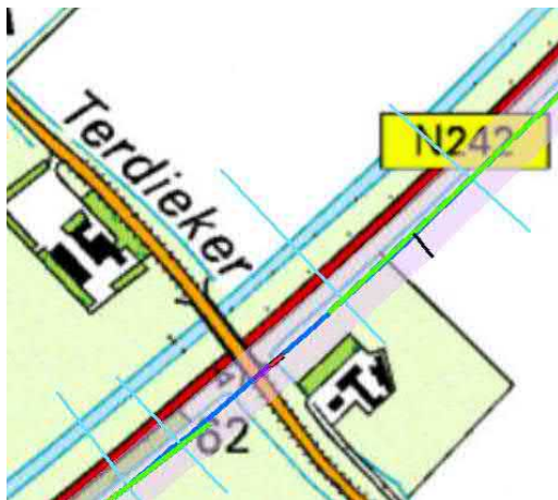
2000: slootdemping (zwarte verticale lijnen; tracé langs slootdemping: groene lijn t.b.v. aanleg N242) ter hoogte van de Terdiekerweg
