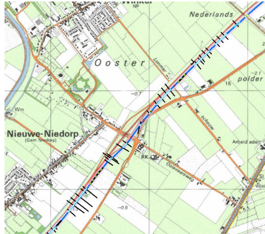
1985: demping sloten (zwarte verticale lijnen; tracé langs slootdemping: blauwe lijn t.b.v. aanleg N242)
