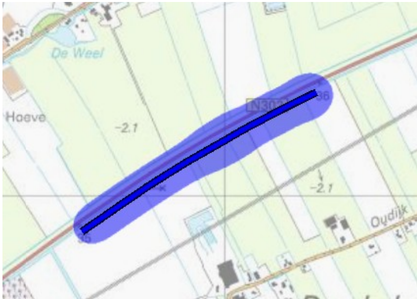
Figuur 8 Ligging van gastransportleiding W-573-14 (blauw). De contouren van het PR van 10^{-8} per jaar van de leiding worden respectievelijk weergegeven met blauwe gebieden.
