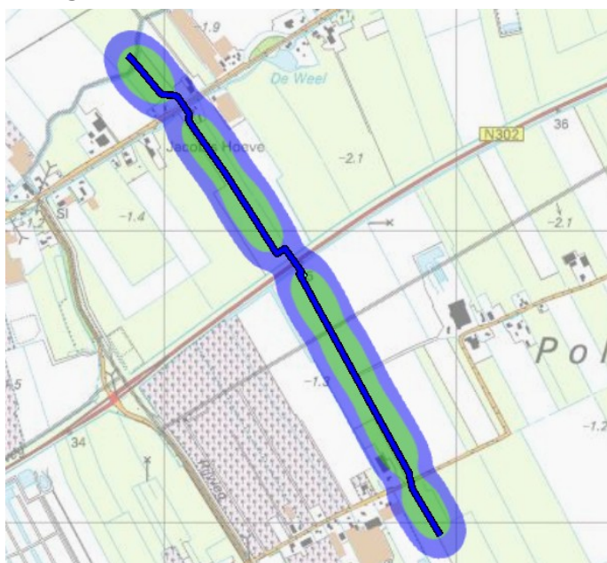
Figuur 7 Ligging van gastransportleiding W-573-09 (blauw) in de huidige situatie. De contouren van het PR van 10^{-7} en 10^{-8} per jaar van de leiding worden respectievelijk weergegeven met groene en blauwe gebieden.
