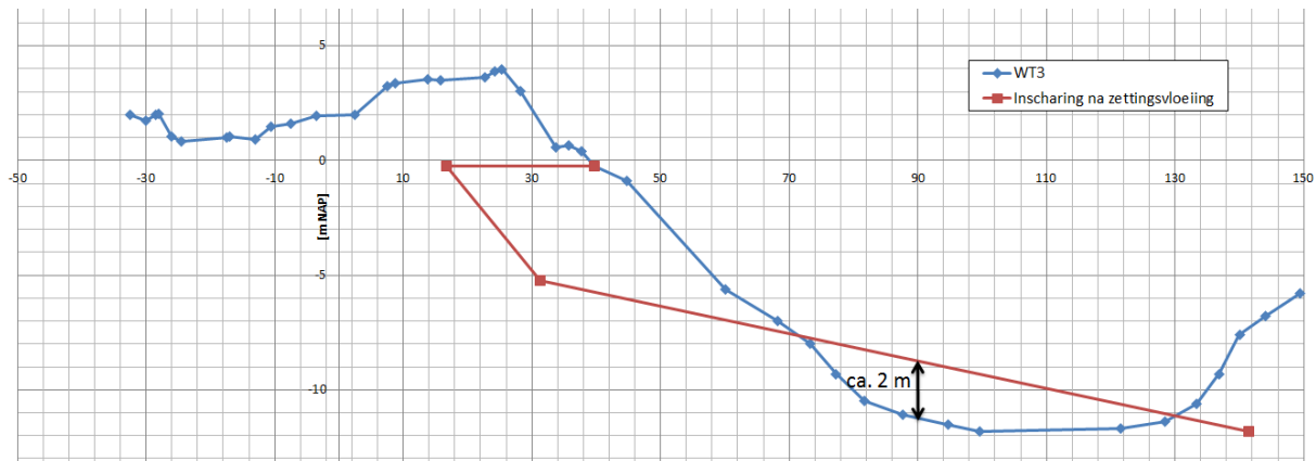
Figuur 5-5: verachte verondieping Binnenspuikanaal bij WTG3 door zettingsvloeiing
