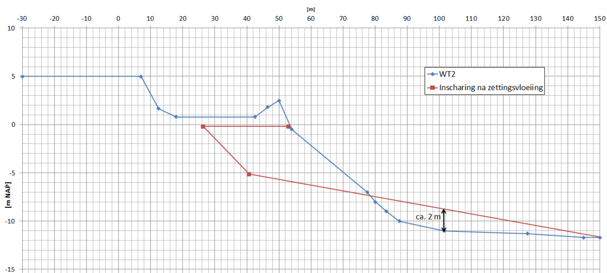
Figuur 5-4: verwachte verondieping Binnenspuikanaal bij WTG2 door zettingsvloeiing
