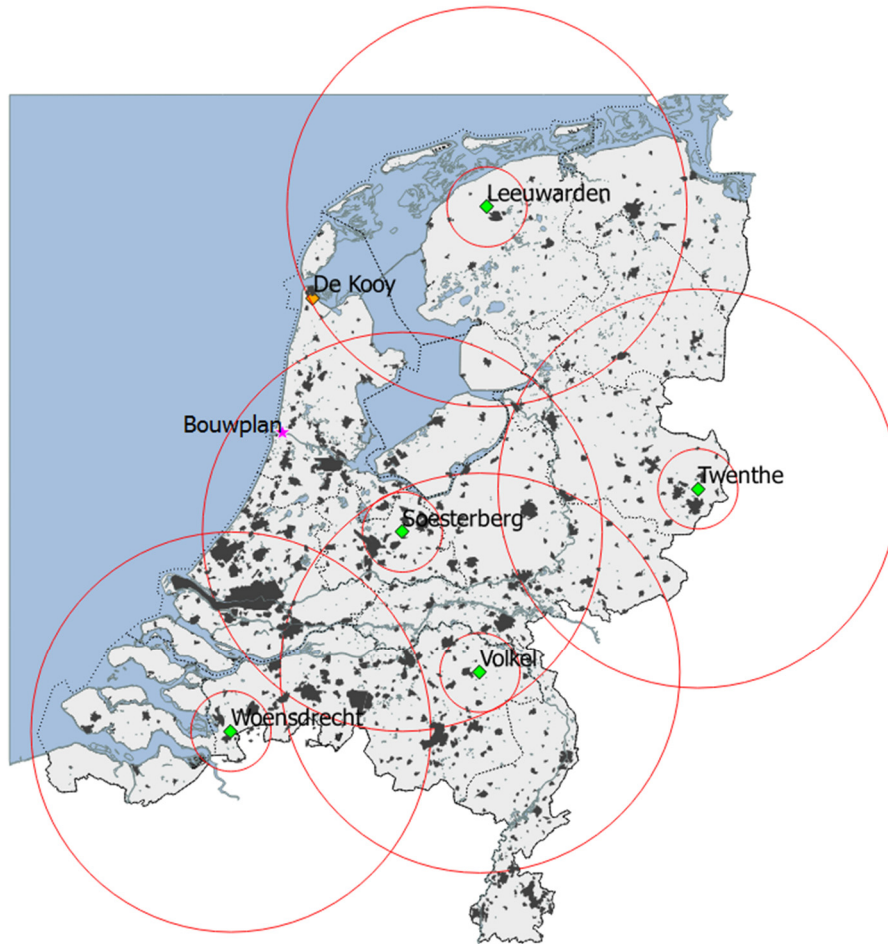
Figuur 2. Locaties van de vijf MASS verkeersleidingsradarsystemen (groene ruit) met daaromheen de 15 en 75 km cirkels. De extra MASS radar op De Kooy is aangegeven met een oranje ruit. De donkergrijze vlakken zijn de in de AHN-1 gedefinieerde stedelijke gebieden. De ligging van het te toetsen bouwplan is aangegeven met een roze ster.
