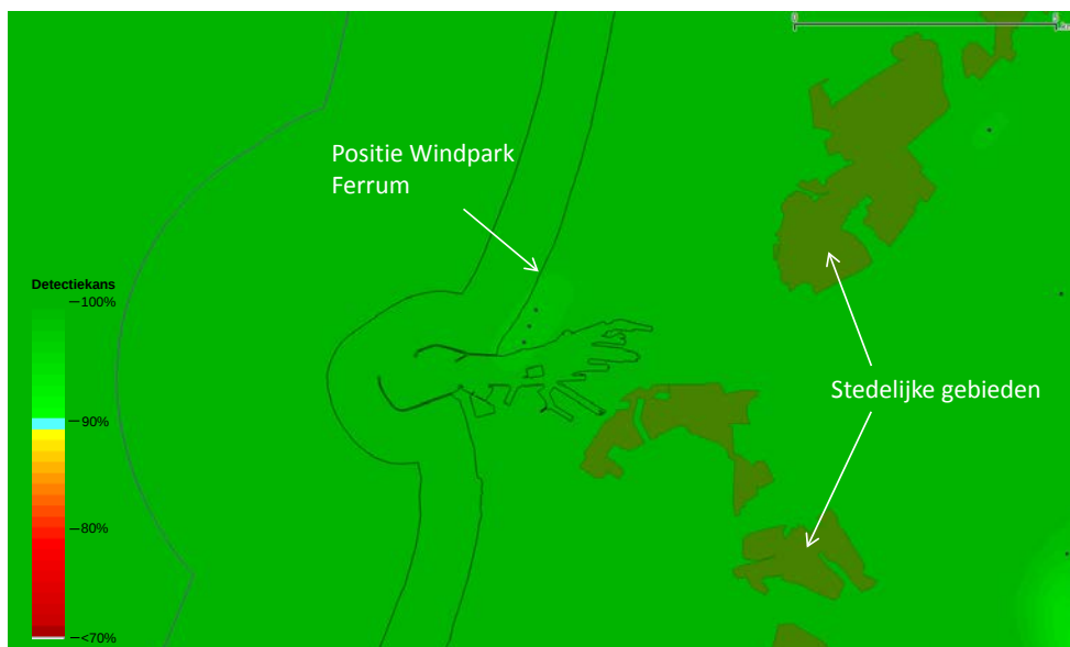
Figuur 5 Detectiekans van het MASS primaire verkeersleidingsradarnetwerk op 1000 voet boven het bouwplan voordat dit is gerealiseerd (baseline).
