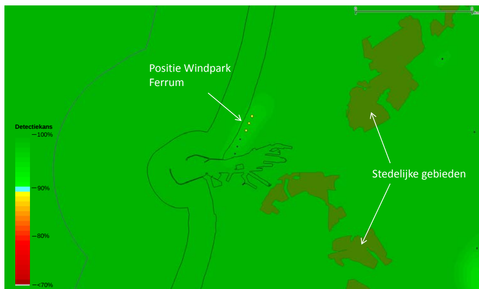
Figuur 6 Detectiekans van het MASS primaire verkeersleidingsradarnetwerk op 1000 voet boven het bouwplan nadat deze is gerealiseerd. De locaties van de windturbines zijn aangegeven met gele stippen.
