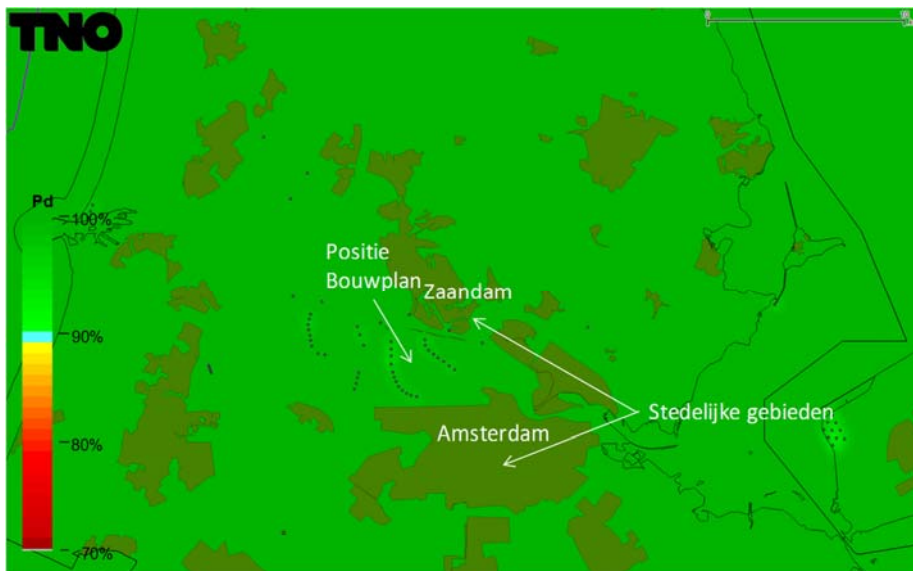
Figuur 6 Detectiekans van het MASS en TAR West verkeersleidingsradarnetwerk op 1000 voet boven het bouwplan voordat dit is gerealiseerd (baseline). Op dit figuur is detectiekansmiddeling toegepast.
