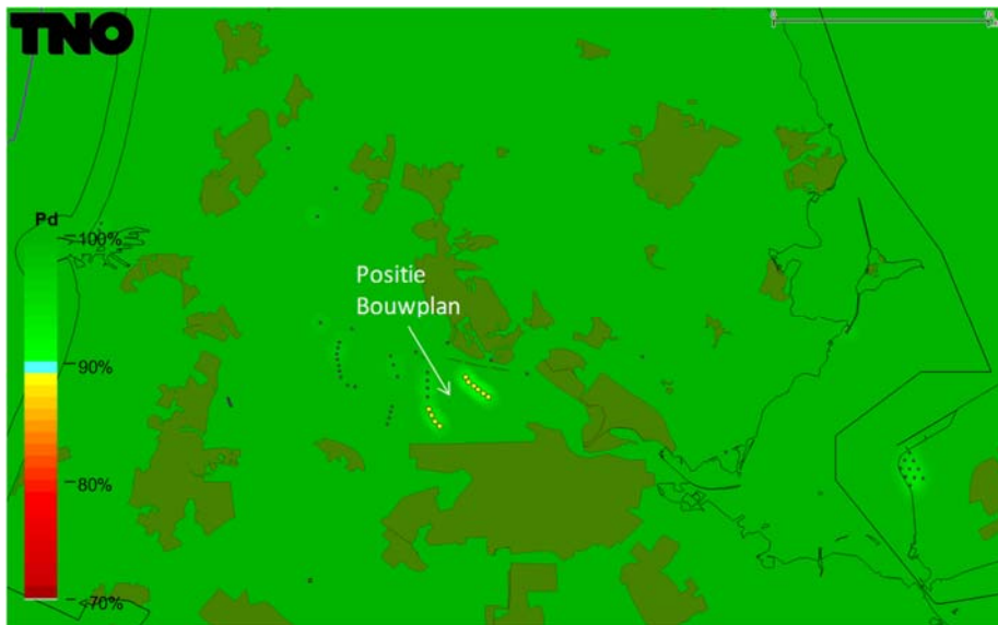
Figuur 7 Detectiekans van het MASS primaire verkeersleidingsradarnetwerk op 1000 voet boven het bouwplan nadat deze is gerealiseerd. De locaties van nieuwe windturbines zijn aangegeven met gele stippen. Op dit figuur is detectiekansmiddeling toegepast.
