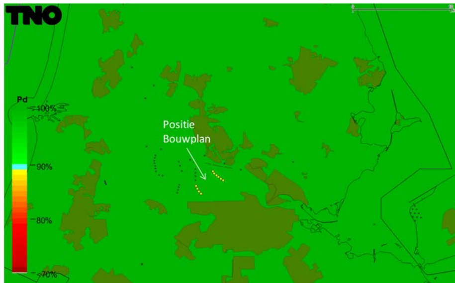
Figuur 13 Detectiekans van het MASS en TAR West verkeersleidingsradarnetwerk, aangevuld met de extra MASS radar te De Kooy, op 1000 voet boven het bouwplan nadat deze is gerealiseerd. De locaties van nieuwe windturbines zijn aangegeven met gele stippen. Op dit figuur is detectiekansmiddeling toegepast.
