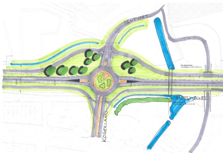
Afbeelding 24 Voorgestelde inrichting rotonde Snevert/ Kogerlaan
