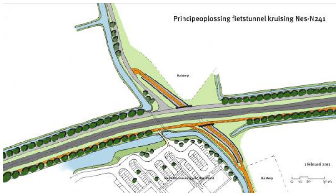
Afbeelding 26 Principeoplossing fietstunnel Nes Noord (Oranjewoud, februari 2011)
