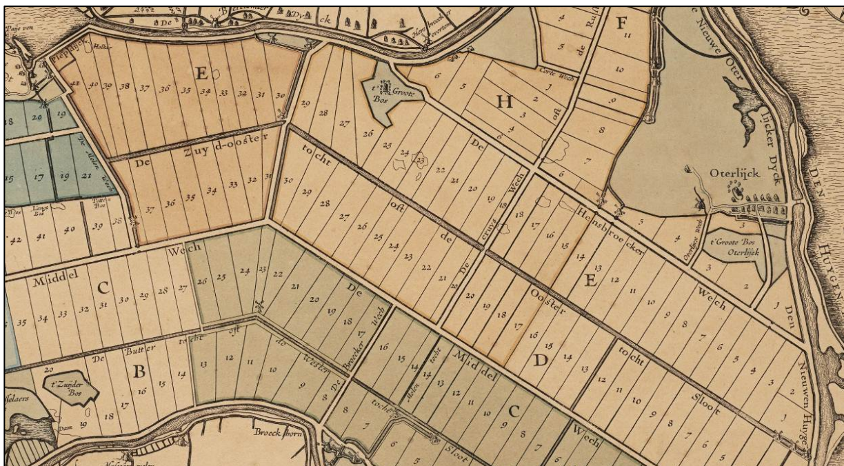
Afb. 33: Op deze uitsnede van de verkavelingskaart van de Heerhugowaard uit 1631 is de langwerpige vakindeling en de nummering van de kavels goed te zien. De kavels staan haaks op de tochten en wegen. De kavellengte ligt meestal tussen 750 en 800 meter en de breedte varieert van 150 tot 200 meter.
