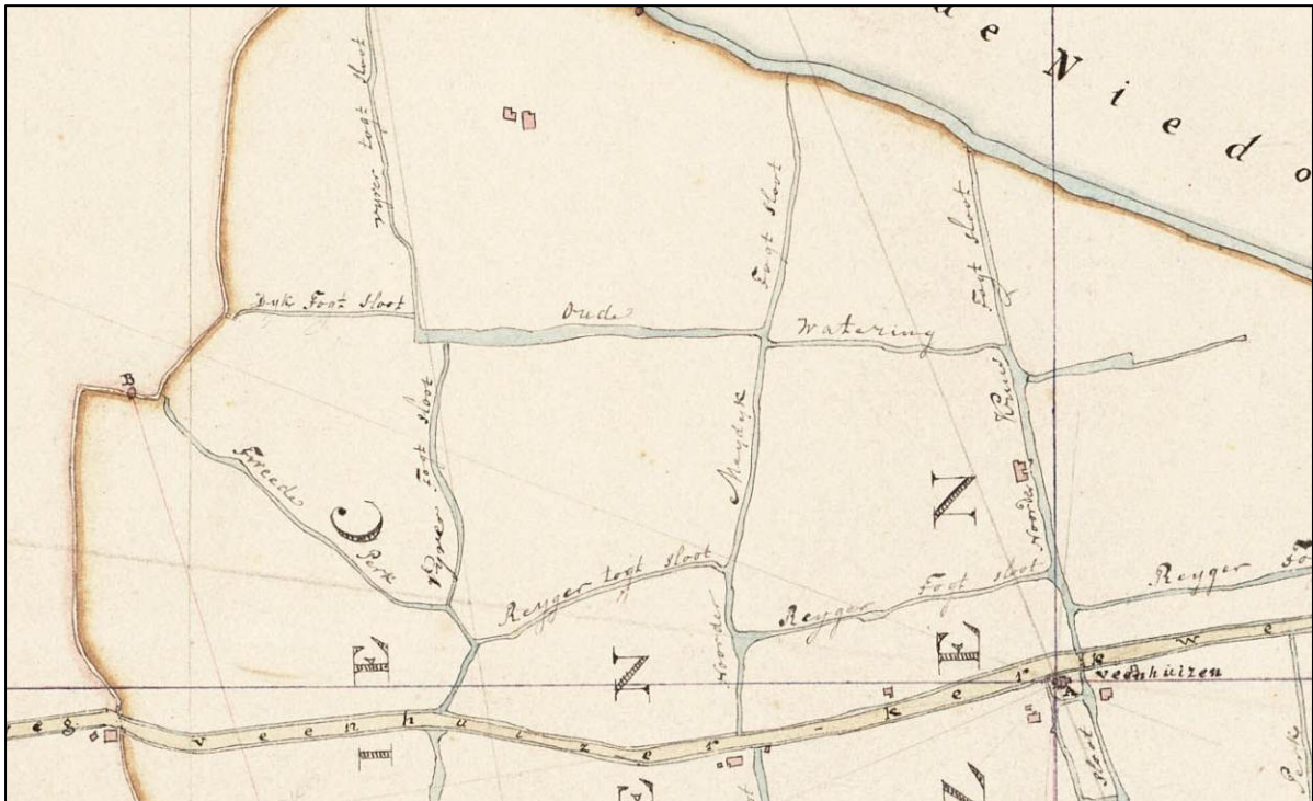
Afb. 15: Op het minuutplan van de gemeente Veenhuizen, dat in 1817 door landmeter van de eerste klasse J.J. Nautz werd opgenomen, is links de kronkelige Groenedijk te zien, voordat deze in de twintigste eeuw op twee plaatsen werd rechtgetrokken. Daarnaast zijn alle tochten en sloten van Veenhuizen in één oogopslag te zien en bij naam genoemd. Veel tochten waren opgedeeld in een noordelijk en zuidelijk gedeelte. De belangrijkste afvoertochten waren de Zuider- en Noorderkruistochtsloot en de Oude Watering.
