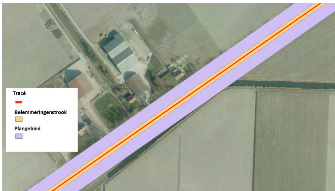
Afbeelding 5: Kabeltracé (rood), belemmeringenstrook (oranje) en plangebied (paars).
