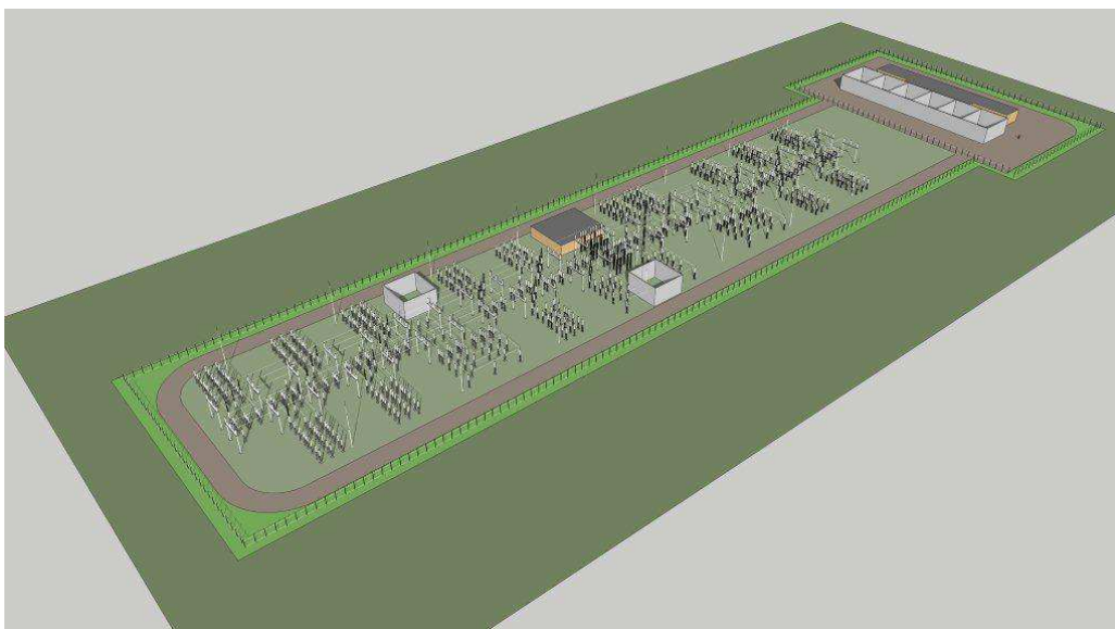
Figuur 1.1 Impressietekening van het nieuwe 150/20 kV station
