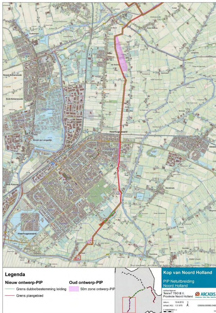
Afbeelding 6 Verschil plangrens oude ontwerp PIP en nieuwe ontwerp PIP voor tracé DWL-OTL
