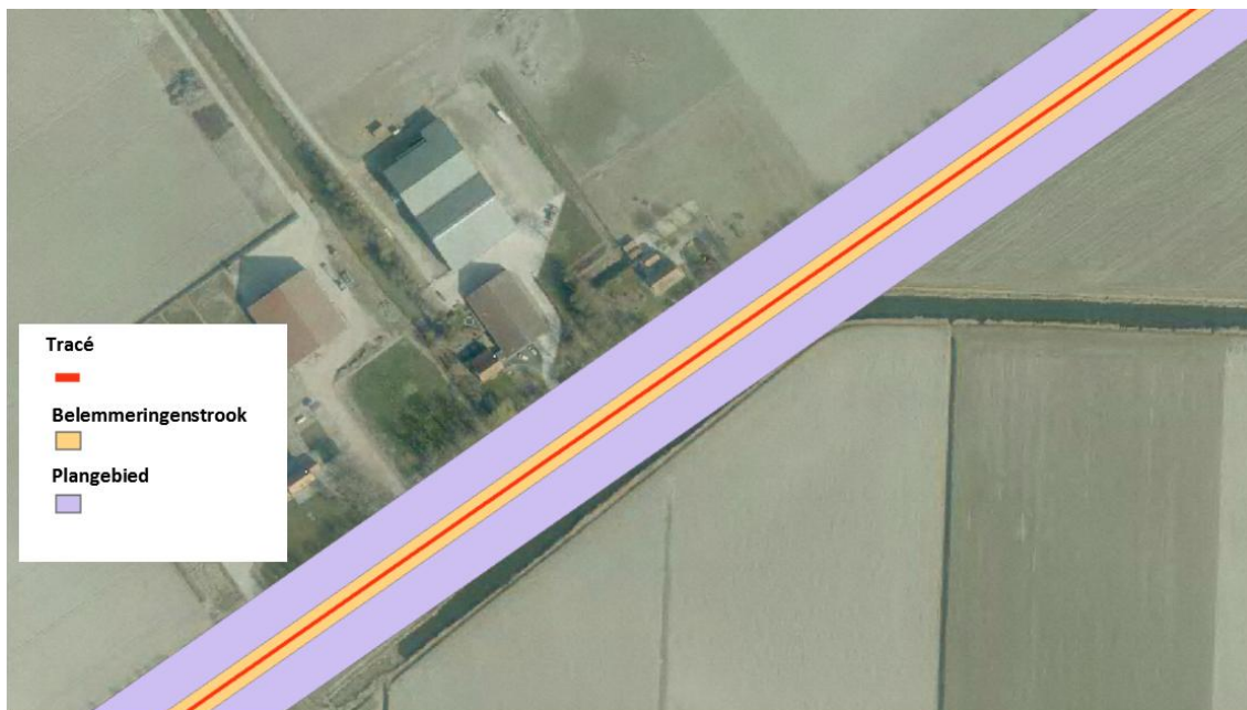
Afbeelding 5: Kabeltracé (rood), belemmeringenstrook (oranje) en plangebied (paars).
