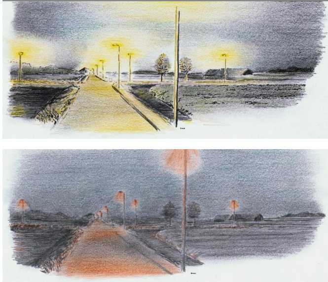
Figuur 4.8 Een voorbeeld van verschil in verlichting. De onderste foto geeft een wenselijke situatie voor vleermuizen; afgeschermd armaturen
