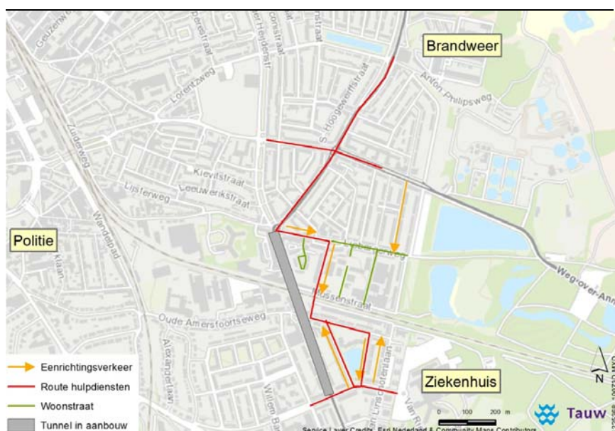
Figuur 4.11 Routing hulpdiensten tijdens bouwfase Oosterengwegtunnel
