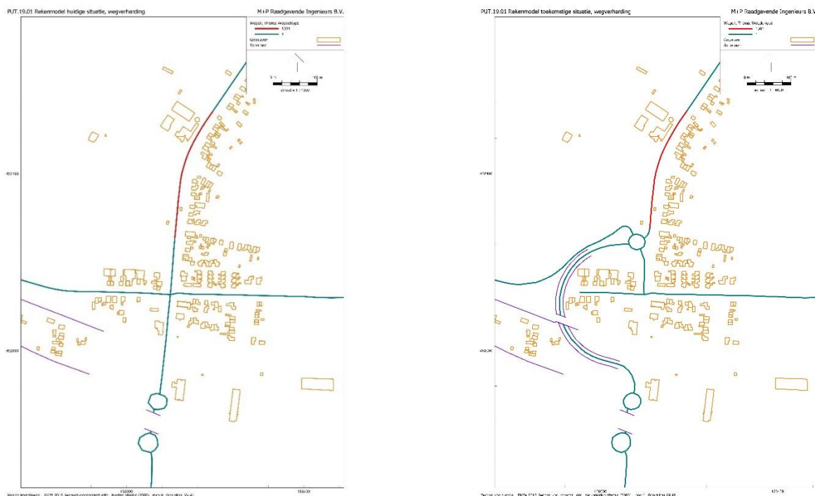
figuur 3 wegverhardingen in de huidige situatie (links) en de toekomstige situatie (rechts): in groen DAB, in rood SMA-NL8 G+.
