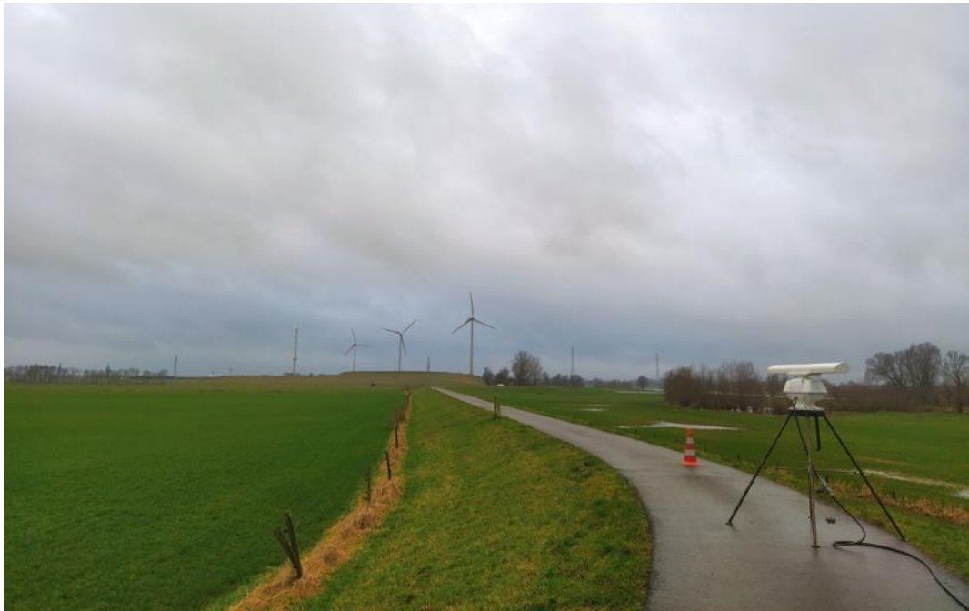
Figuur 2.1 Opstelling horizontale radar (Furuno 25 kW) voor onderzoek naar slaaptrek van watervogels.
