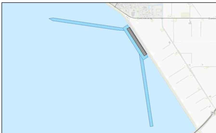
Figuur 3-2 ontgravingscontour L-variant, in grijs het havendok en blauw de ontgravingscontouren
