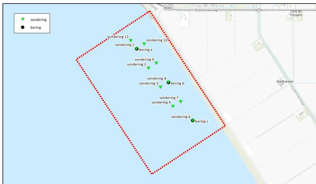
Figuur 2-5: Uitgevoerd veldwerk rondom de werklocatie
