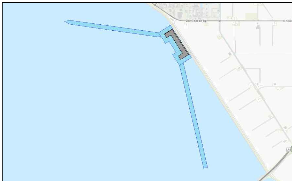
Figuur 3-3 ontgravingscontour U-variant, in grijs het havendok en blauw de ontgravingscontouren
