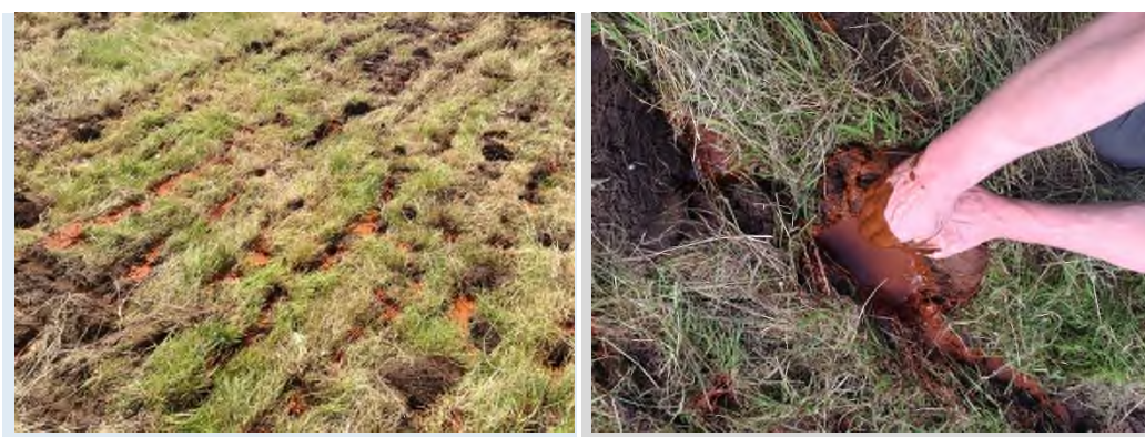
FIGUUR 4-6. HET IJZERSLIB WERD IN PARALLELE SNEDES TUSSEN EN ONDER DE GRASZODE AANGEBRACHT (LINKS). OP DE RECHTERFOTO IS TE ZIEN DAT HET IJZERSLIB TOT EEN DIEPTTE VAN 15-20 CM IS INGEBRACHT.
