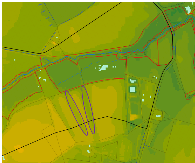
Figuur B4. De cirkels geven aan waar vier drainagestrengen voorkomen die als gevolg van de maatregelen uit het inrichtingsplan niet meer kunnen functioneren. De ondergrond is de maaiveldhoogtekaart (AHN2) waarbij elk kleurverschil een hoogteverschil van 0,5 m aangeeft. Rode en zwarte begrenzing geeft respectievelijk de Natura2000- en stroomgebiedsbegrenzing weer.
