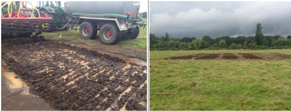
FIGUUR 4-4. A) INBRENGEN VAN HET IJZERSLIB OP HET DEEL ZONDER ZODE. B) ZICHT OP DE VIJF PROEFSTROKEN VANAF OOSTELIJKE ZIJDE.
