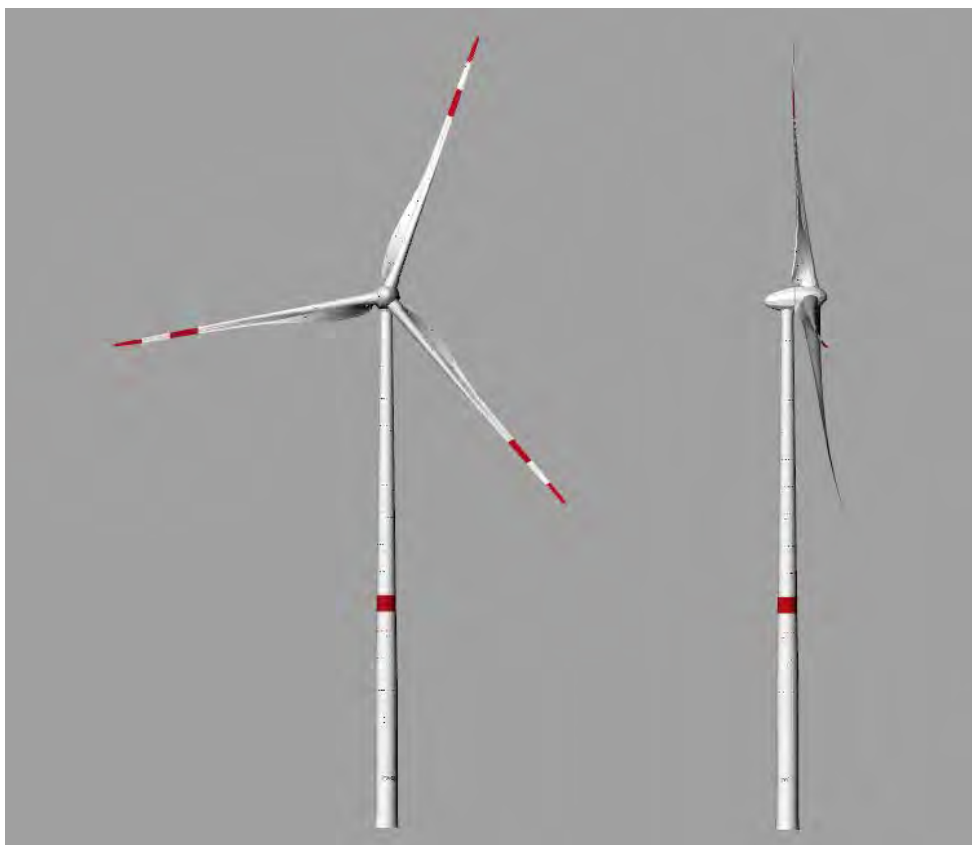
Figuur 5. De windturbine van Enercon, type E103 EP2, met een opgewekt vermogen van 2.35 MW, een ashoogte van 98.4 m en een rotordiameter van 103 m.
