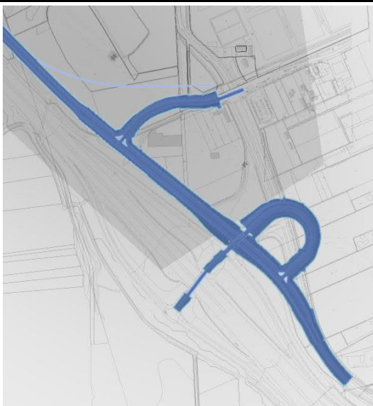
Ontwerp Vloedbeltverbinding aansluiting A1/A35 Borne-West
