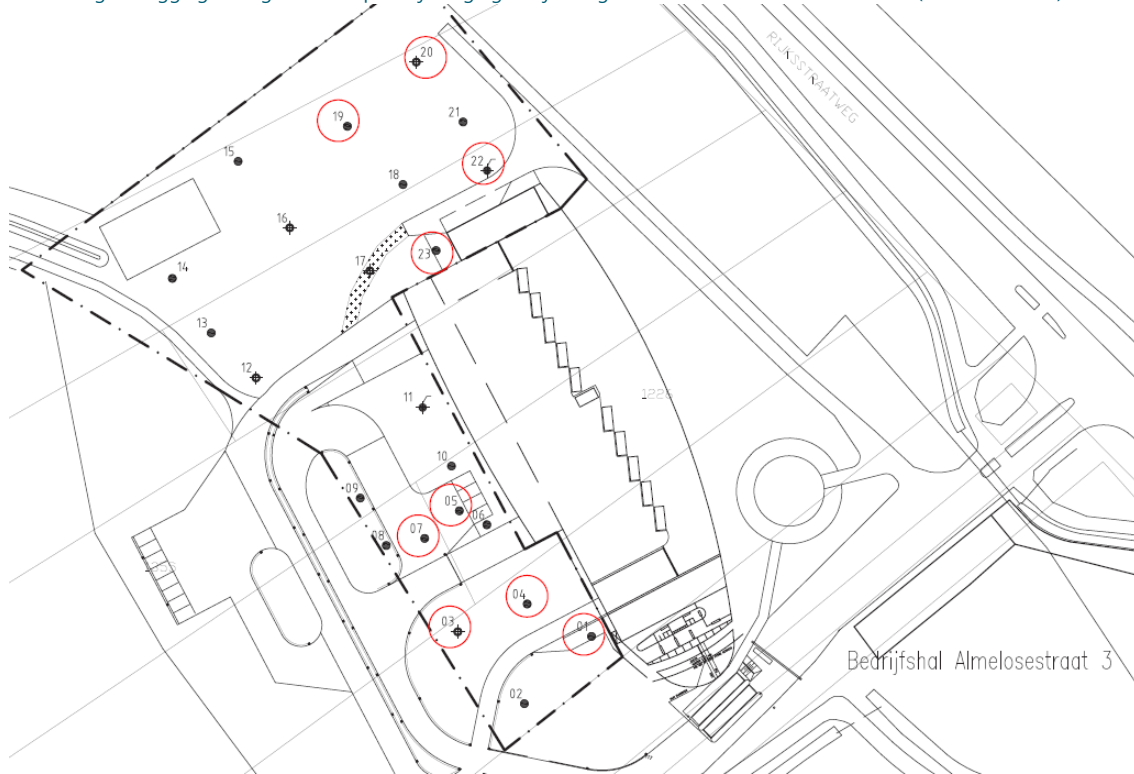
Afbeelding 2.3 Ligging boringen waarin puinbijmengingen zijn aangetroffen in het onderzoek uit 2014 (rood omcirkeld)
