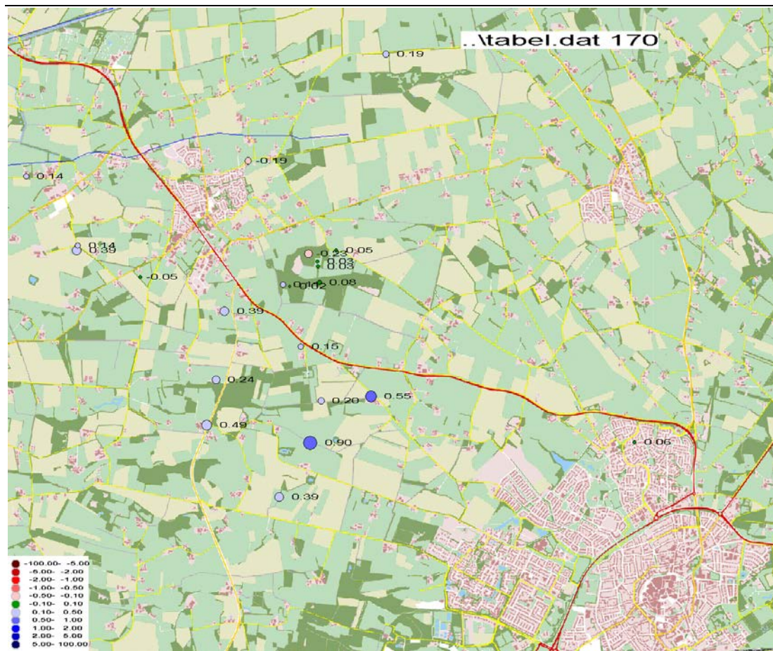
Figuur 3.3 Afwijking stationaire model in laag 2 ten opzichte van de gemiddelde grondwaterstand
