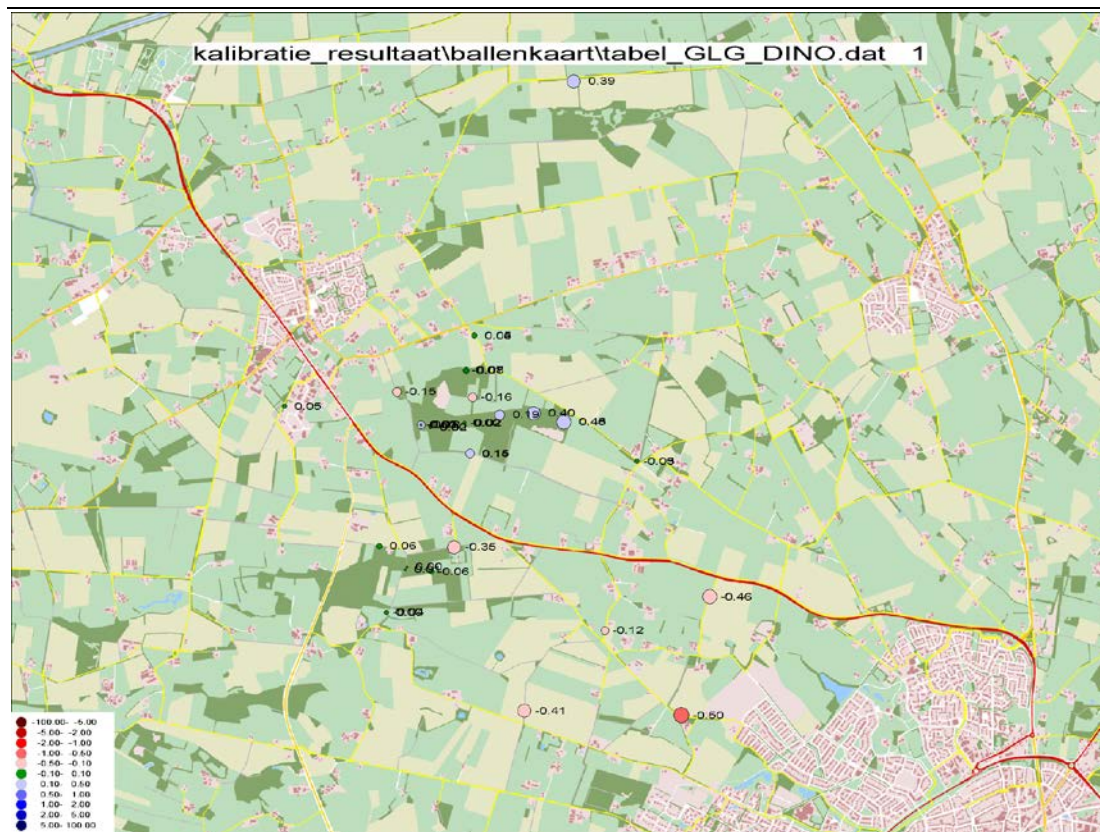
Figuur 3.14 Afwijkingen van het model ten opzichte van de GLG in modellaag 3
