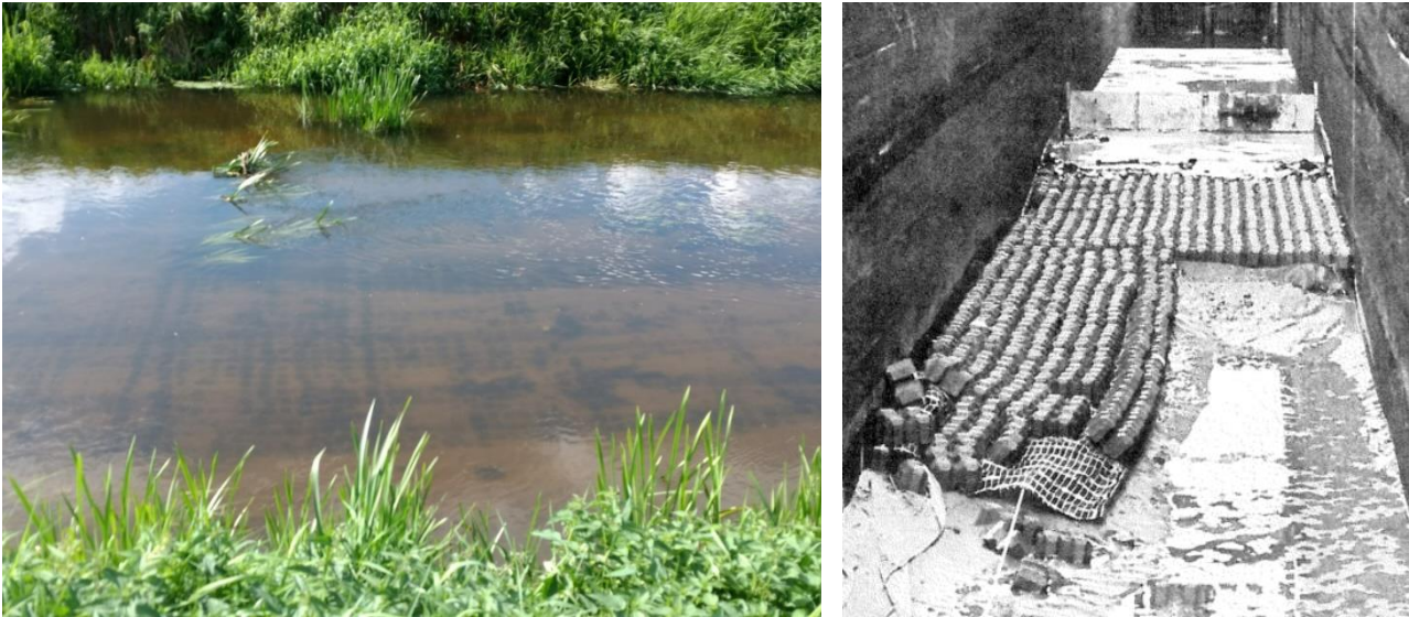
Figuur 2-7 Foto impressie van Gobi-matten in de Dinkel. Links: Gobi-matten op de bodem van de Dinkel (Bron: Waterschap Vechtstromen, 2019). Rechts: Gobi-matten in een stroomgoot aan het eind van een experiment met turbulente stroming (Derks, 2013).
