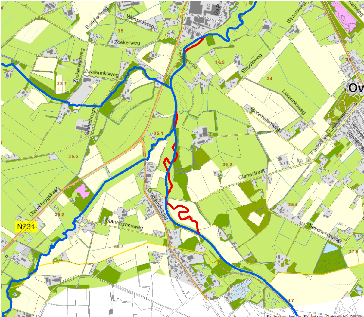
Figuur 1. Ligging huidige loop Dinkel (blauw) en de toekomstige loop van Dinkel variant 3a (rood). Opgemerkt wordt dat de vorm van de meanders in de nieuwe loop iets is gewijzigd in het nieuwste ontwerp. Dit zal leiden tot zeer lokale verschillen met de in dit rapport berekende effecten.
