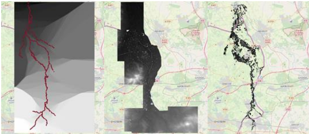
Figuur 2.2 Figuur 3.1 Waterhoogtes (links) met daarover de rekenpunten, de DEM (midden) en de resulterende waterdieptekaart (rechts)
