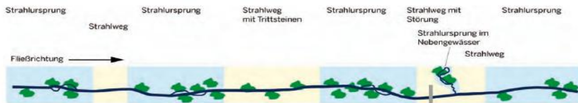
Abbildung 2: Schematische Darstellung der Funktionselemente des Strahlwirkungs- und Trittsteinkonzeptes (nach DRL 2008)
